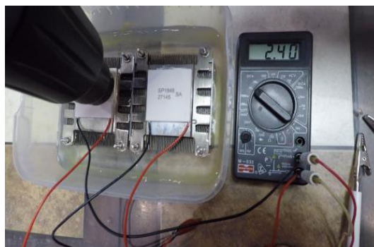
Рис. 6. Генерация энергии с помощью модулей Пельтье (два модуля)
