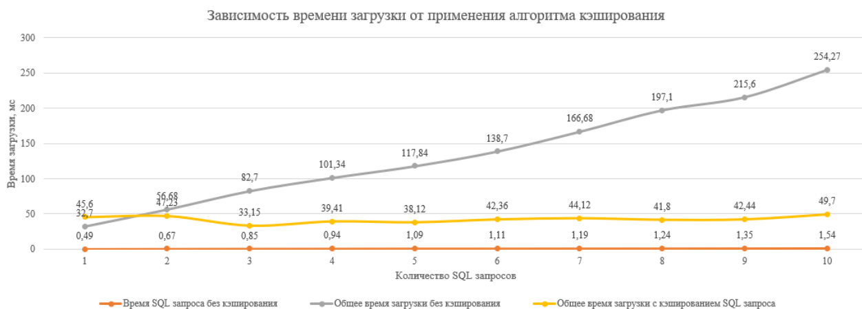
Рис. 8. Зависимость времени загрузки от количества запросов к базе данных и применения кэширования
