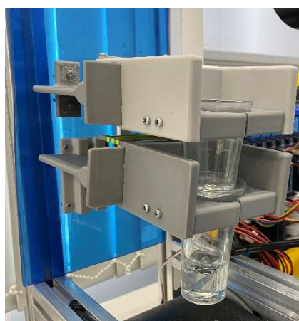
Рис. 4. Собранное устройство по выдачи бокалов
