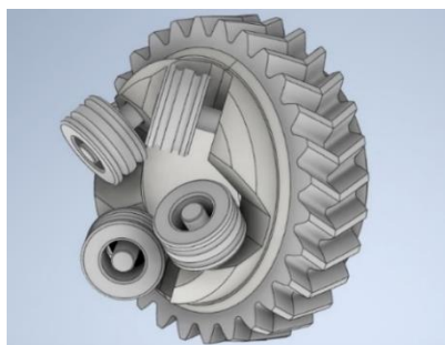
Рис. 3. Безрезьбовой роликовый винт
