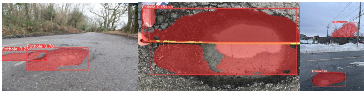
Рис. 4. Примеры недостоверных результатов сегментации YOLOv8s-seg на тестовых изображениях UDTIRI
