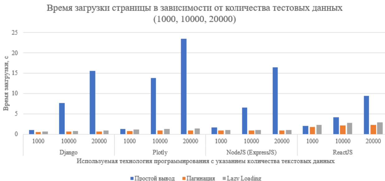
Рис. 6. Зависимости времени отображения текстовых данных на веб-странице от способа оптимизации
