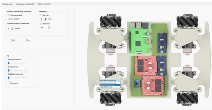
Рис. 3. Приложение для демонстрационного управления двигателями
