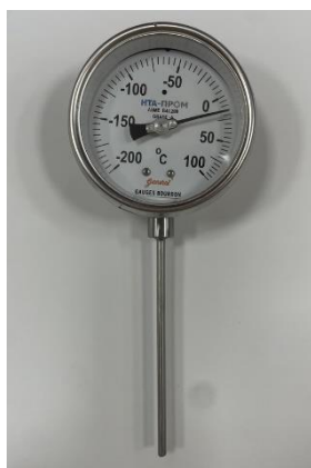
Рис. 2а. Реальный вид термометра
