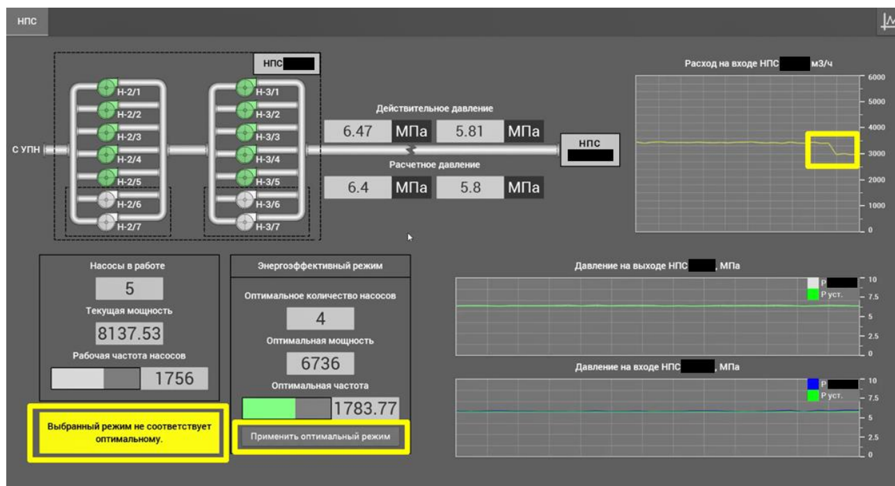
Рис. 1. Мнемосхема СППР оптимизации энергопотребления
