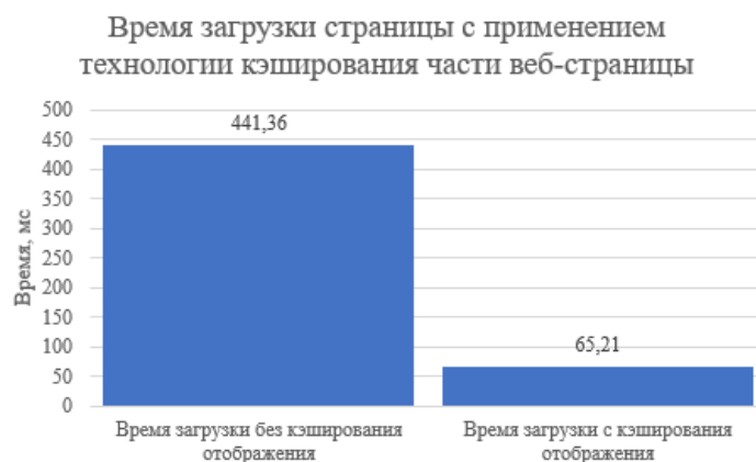
Рис. 9. Зависимость времени загрузки от применения кэширования части веб-страницы
