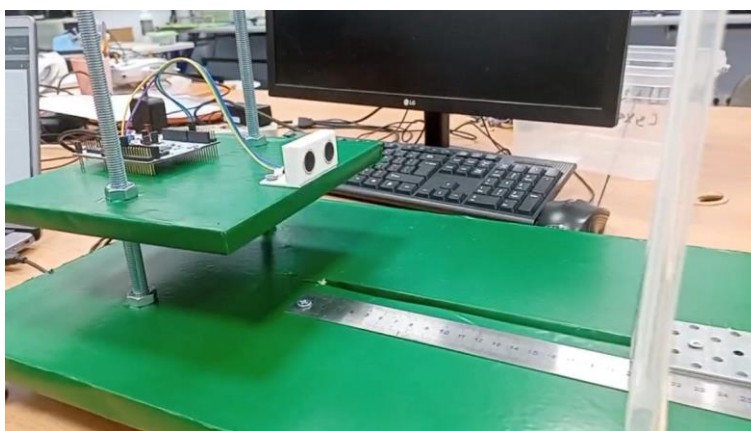
Рис. 5. Стенд для определения погрешностей измерения расстояний с помощью ультразвукового датчика
