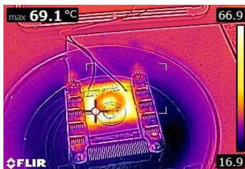
Рис. 5. Нагревание монеты на стенде (тепловизор)
